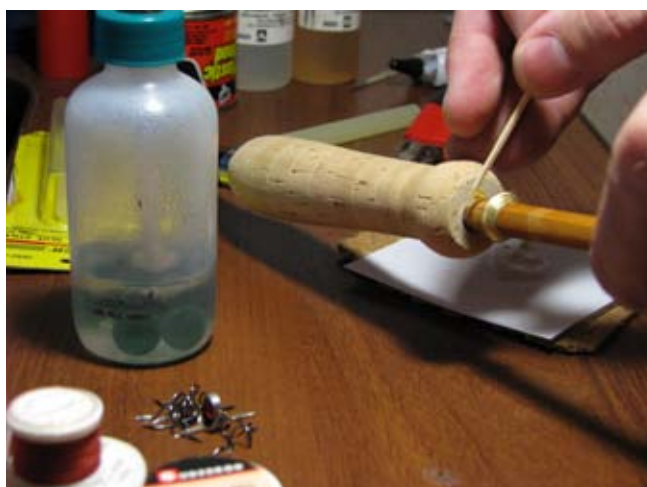
12. Разводим 5-минутный двухкомпонентный эпоксидный клей и приклеиваем декоративное кольцо на пробку.
