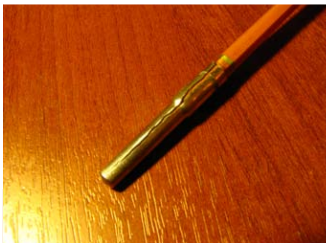
13. При помощи нагрева на спиртовке снимаем старые соединительные втулки.
