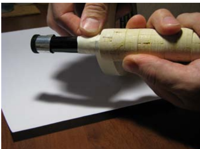
9. Подготавливаем ручку к обработке. Наматываем малярный скотч на катушкодержатель и на бланк сверху ручки, чтобы не повредить их.
