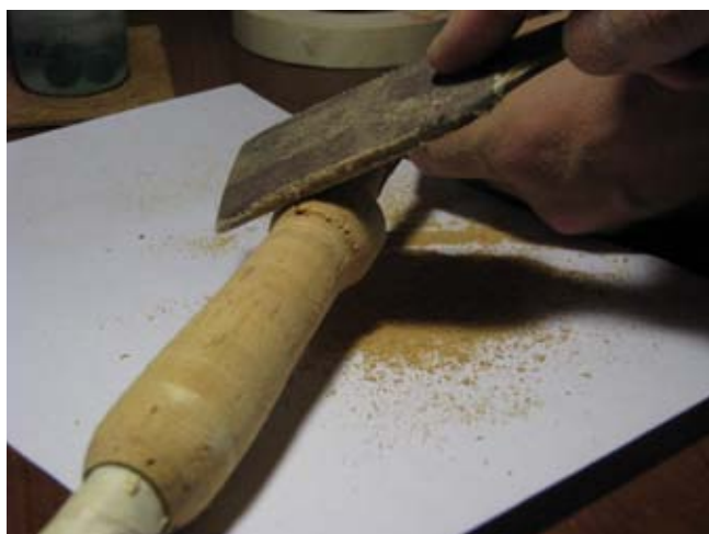
10. Шкуркой, приклеенной на деревяшку, обтачиваем рукоятку до нужной нам формы.
