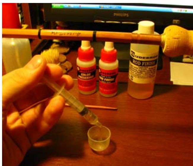
24. Смешиваем двухкомпонентный лак.
