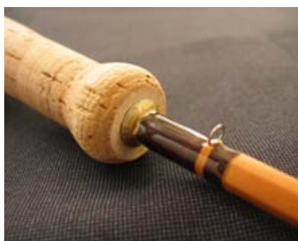
26. Сушим удочку, медленно вращая ее — либо вручную на коробке, либо на специальном станке, следя за тем, чтобы лак не стекал и распределялся равномерно. Когда лак загустеет — оставляем удилище на сутки сохнуть в закрытом чистом помещении без сквозняков, расположив ее кольцами вниз.
