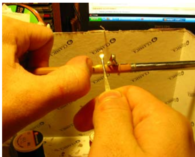
22. Разглаживаем намотку круглым полированным шпателем.
