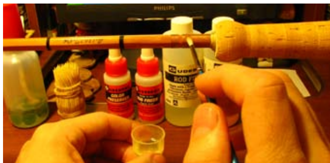
25. Синтетической кисточкой покрываем обмотки лаком.
