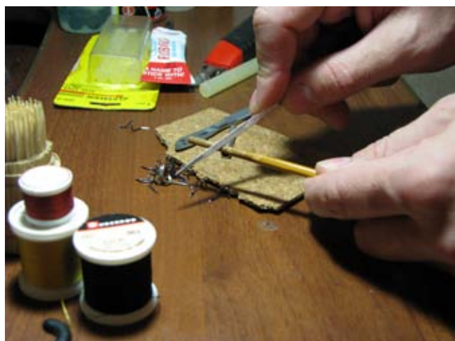
14. Обтачиваем надфилем посадочные места под новые втулки.
