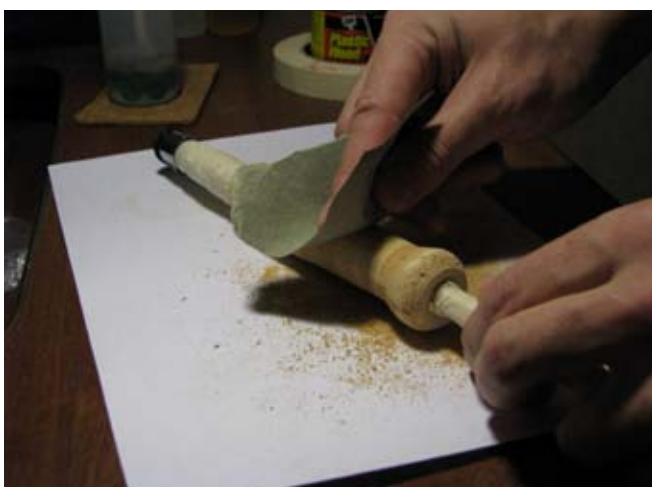
11. Нулевой шкуркой дорабатываем ручку, выбирая все каверны.
