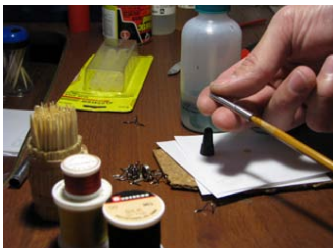
15. Специальным клеем или эпоксидной смолой с пластификатором приклеиваем новые втулки на удище.
